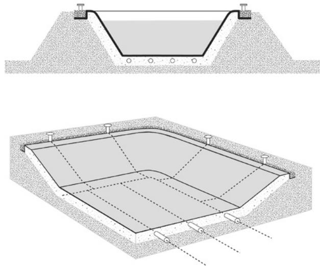
*Abb. 5 : Gasdrainage*
